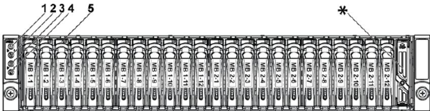
図 1-7. 前面パネル-2.5 インチハードドライブ 24 台とマザーボード 1 枚
